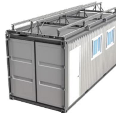
Die Vorrichtung ist an die Standardabmessungen der Photovoltaikmodule angepasst, und die Aufnahmen sind mit den Dächern von 20' Standardcontainern kompatibel. Die Einstellung ermöglicht eine Breite von 2440 oder 3000 mm bei einer Länge von 6050 mm. Sie kann in einfacher oder doppelter Dachform verwendet werden.
