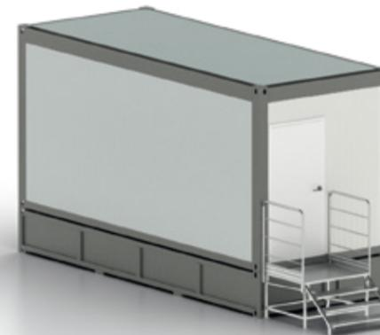
Die Treppe ermöglicht den Zugang zu Schmutzwasserbehältern und kann auch als eine Serviceplattform genutzt werden. Die Stufen bestehen aus geschweißtem Gitterrost, und die gesamte Konstruktion ist feuerverzinkt und somit korrosionsgeschützt.
